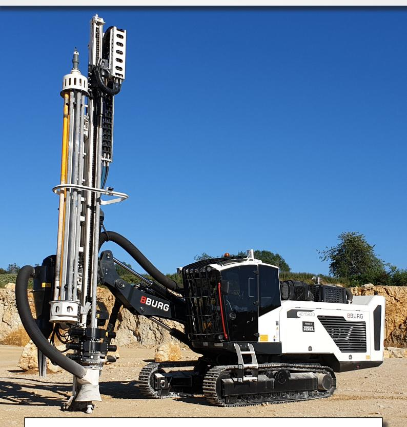
Einsatzbereich Bohrlochdurchmesser Bohrrohrdurchmesser Kompressorleistung Max. Luftdruck Arm-Variante Große Steinbrüche / Minen 89 - 172 mm 76 - 140 mm 28 m³/min 35 bar einteilig
