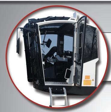
ROPS/FOPS-Überdruckkabine auf Viskosedämpfern gelagert. Kabine mit Heizung und Klimaanlage. Verstellbarer und gefederter Fahrersitz.
