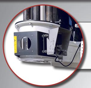
Elektronischer Bewegungsmelder schaltet automatisch Bohrvorschub und Rotation ab, sobald eine Person sich dem vertikalen Bohrstrang annähert
