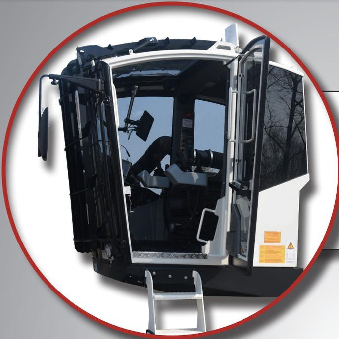
Cabine pressurisée ROPS / FOPS, montée sur amortisseurs visqueux. Cabine avec chauffage et climatisation. Siège conducteur réglable avec suspension.
